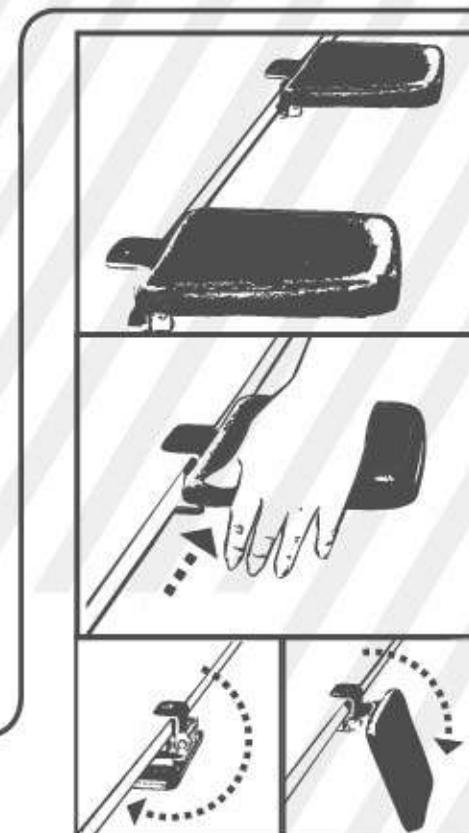
Além do conforto de manter o antebraço apoiado, este modelo possui um dispositivo de fácil acionamento que dobra o apoio sob o tampo da mesa, o que não atrapalha as pernas do usuário e garante a sua discrição.
